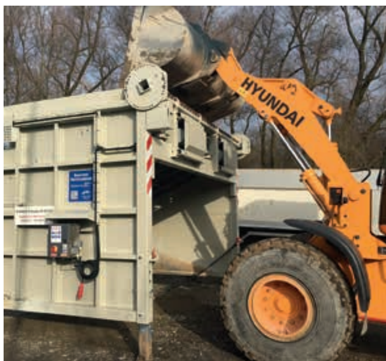
Die SBR 2 kann beidseitig beschickt werden – je nach Material und Lademaschine. Foto: Bratschi Transporte GmbH
