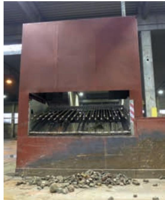
*Dank der robusten Stangensizer-Lösung werden mit der SBR 2 Übermaßgrößen leicht abgeschieden, ohne den Siebbelag zu beschädigen. Foto: BHS Dresden*
