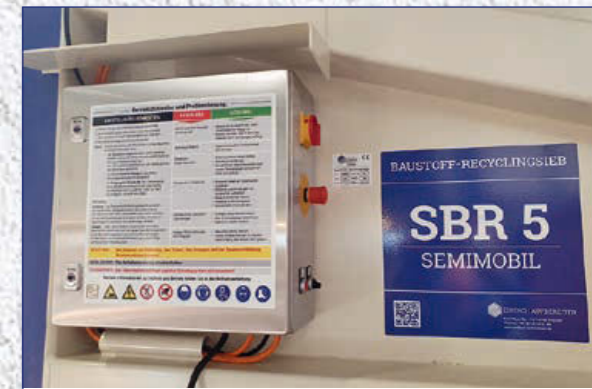
Schaltschrank mit Kurzanleitung
