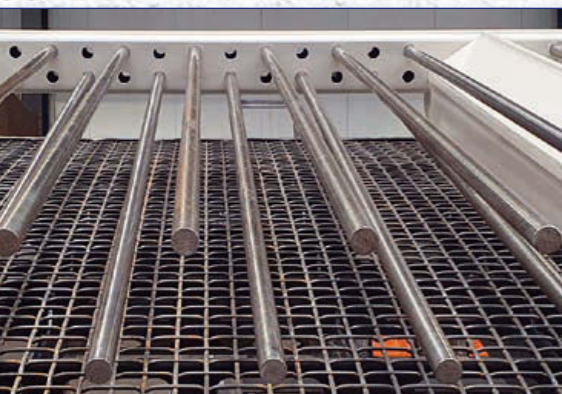
Stangensizer zur Grobabscheidung
