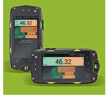
Im Display des Smartphones bekommt der Fahrer in Echtzeit das Gesamtgewicht seines Fahrzeuges angezeigt, das auf Wunsch als „rugged“ Android-Gerät mitgeliefert wird FOTO: OUTSET
