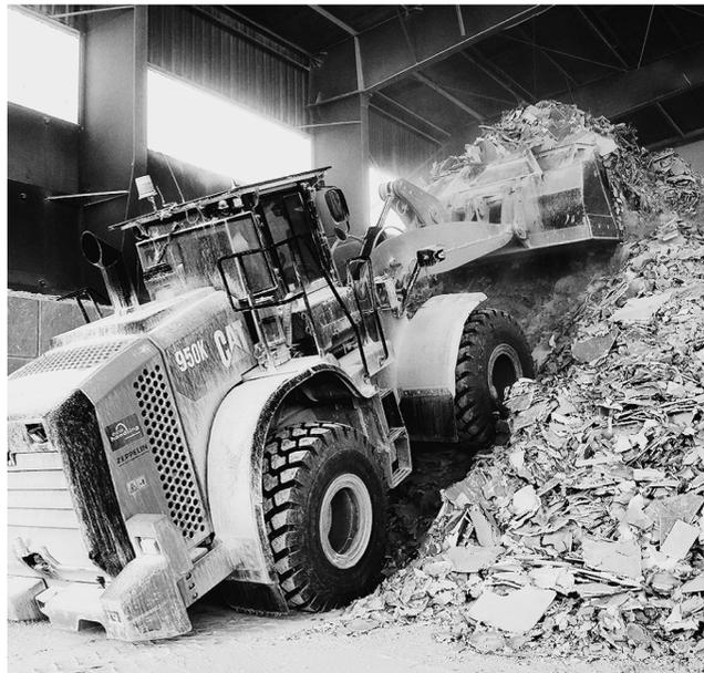
Die Firestone MULTI BLOCK T Reifen bieten den Radladern der MUEG auch auf losem Untergrund und bei starker Steigung bestmögliches Fahrverhalten, so das Unternehmen. FOTO: BRIDGESTONE/ANDREAS BEIL
