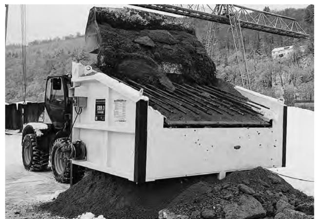
Vom Restbeton zum Recycling-Beton – Aufbereitung trotz Schnee und Eis mit dem SBR3. FOTO: EAG EINFACH AUFBEREITEN
