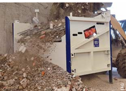
Baustoff-Recycling-Sieb SBR 4 als Bauschuttvorsieb.
