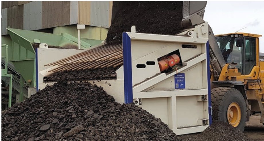
Die größere Siebanlage SBR 4 kann mit Radladern mit Schaufelinhalt von bis zu 5 m 3 beschickt werden.
