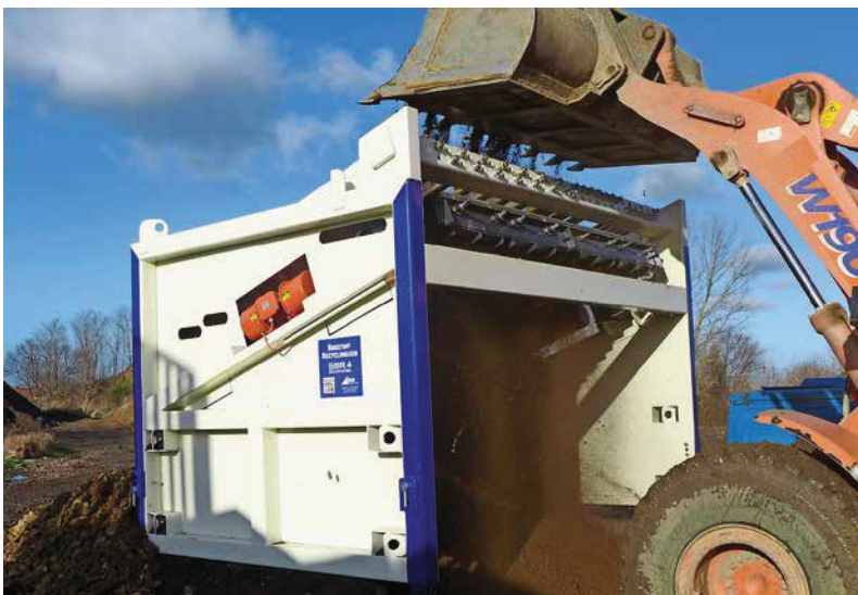
Ausgelegt ist die SBR 4 für Radlader mit ca. 4 m 3 Schaufelinhalt
