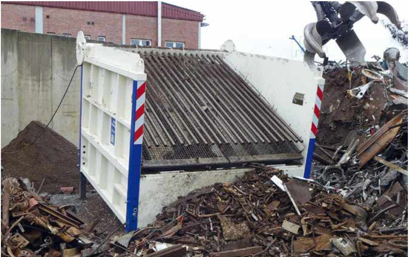
Die SBR 1 hat sich bei der Absiebung von Verladereesten bei der ISR in Hamburg als eine sehr flexible und zuverlässige Siebmaschine erwiesen. Foto: BHS Innovationen GmbH
