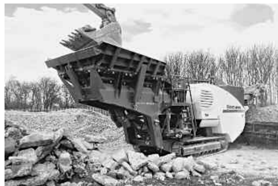
Vielseitig einsetzbar ist der mobile Backenbrecher MC 100 R Evo aus der neuen Kleemann Evo-Generation mit einer maximalen Aufgabelleistung von 220 t/h. FOTO: WIRTGEN
