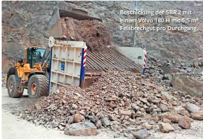
Beschickung der SBR 2 mit einem Volvo 180 H mit 5,5 m<sup>3</sup> Felsbrechgut pro Durchgang.
