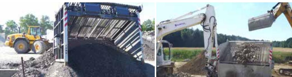
>> Mit dem Fokus auf die Einsparung von Prozesskosten in den hauseigenen Asphaltmischwerken entwickelte das Dresdner Unternehmen BHS sein eigenes Baustoff-Recyclingsieb. Das Ergebnis: die SBR2 - eine Siebmaschine, die durch einfache Funktionalität, Robustheit und hohen Massedurchsatz in Kombination mit einem guten Preis-/Leistungsverhältnis überzeugt.
