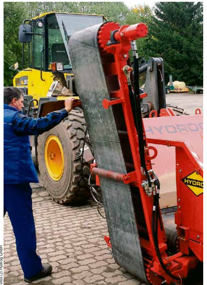
Die Höhenregulierung geschieht hydraulisch über den kurzerhand umgesteckten Hydraulikhubzylinder der Einbauschar des Bankettfertigers. Nach dem hydraulischen Hochfahren lässt sich das Band mit einer Hand in die Verriegelungsposition bringen, um anschließend die Maschine umzusetzen oder wegzufahren.
