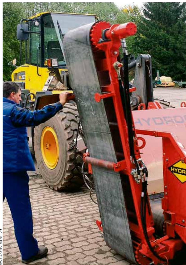
Die Höhenregulierung geschieht hydraulisch über den kurzerhand umgesteckten Hydraulikhubzylinder der Einbauschar des Bankettfertigers. Nach dem hydraulischen Hochfahren lässt sich das Band mit einer Hand in die Verriegelungsposition bringen, um anschließend die Maschine umzusetzen oder wegzufahren.
