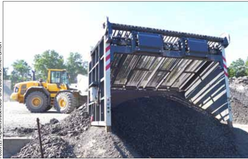
Die SBR 2 im Einsatz im Asphaltmischwerk zur Reduzierung von Brechkosten.
