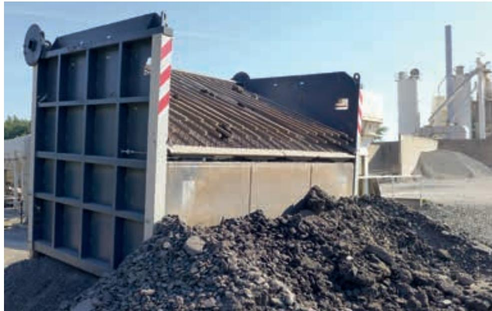
Die SBR 2 hat u. a. geringe Energieverbrauchskosten von ca. 0,25 € pro 100 t und erreicht bei Beschickung mit einem Radlader einen Materialdurchsatz bis zu 100 t/h.
